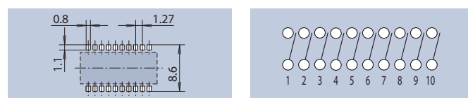
Layoutvorschlag · Layout Suggestion Schaltbild · Wiring Diagram
